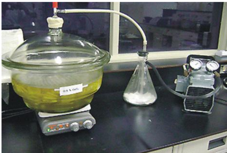
Figura 3.- Equipo de deshidratación osmótica a vacío, instalado.
